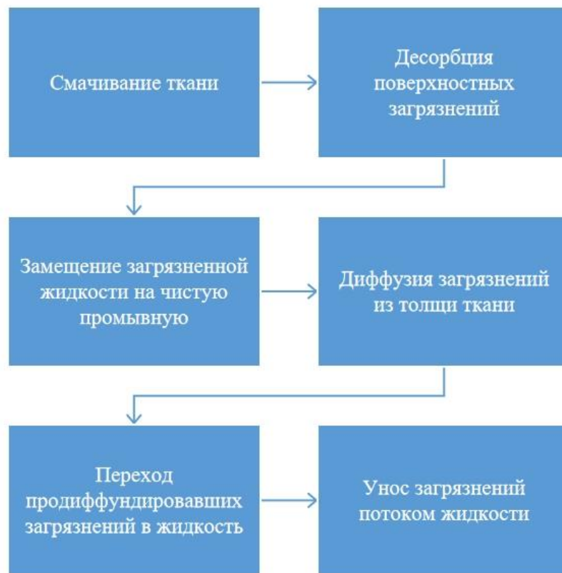
Рисунок 1.4 - Схема стадий процесса промывки [17]
